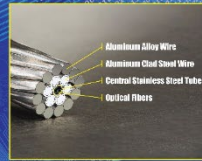
Construction of OPGW
